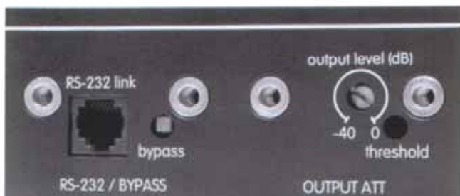
De inregelpunten zijn verzegelbaar middels afdekplaatjes.
