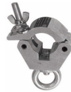
CUP 07 Collier d'accroche à anneau aluminium ø 50 mm – charge max. : 200 kg Aluminium coupler with ring ø 50 mm – max. load : 200 kg
