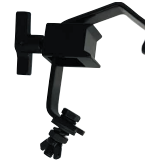
CLM 55 Crochet acier avec contre-plaque de protection pour tube ø 50 mm – charge max. : 40 kg Hook clamp with protection plate for tube ø 50 mm – Max load. : 40 kg
