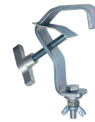
CLM 20 Crochet acier avec contre-plaque de protection pour tube ø 50 mm – charge max. : 20 kg Hook clamp with protection plate for tube ø 50 mm – Max load. : 20 kg
