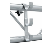
GF 03 Crochet acier forte charge avec contre-plaque de protection pour tube ø 30/60 mm – charge max. : 200 kg Heavy-duty Hook clamp with protection plate for tube ø 30/60 mm – Max load. : 200 kg
