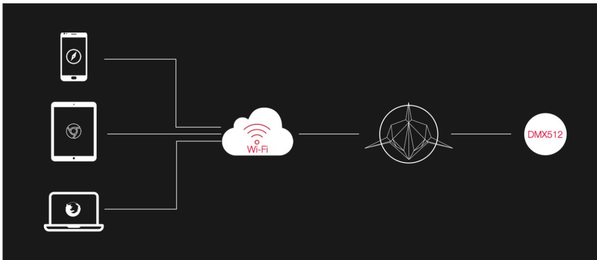
El software LightShark siempre está ejecutándose dentro de la consola (LS-Core o LS-1), en la conexión WiFi entre tu dispositivo y la consola solamente viajan datos de la interfaz de usuario, nunca datos DMX.
