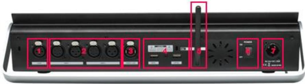
1- Puerto de conexión Flexo luz 5V
