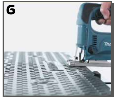
6 Die CROSS 5 SEKTIONEN können einfach mit einer Säge halbiert werden. Das ergibt weitere Kombinationsmöglichkeiten.
